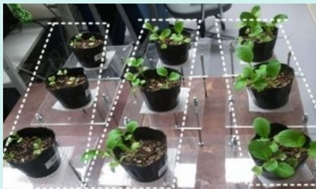
高電圧電源により生成したプラズマを、コマツナの栽培水に照射し生長を促進 (左から、照射なし、10分照射、20分照射)
