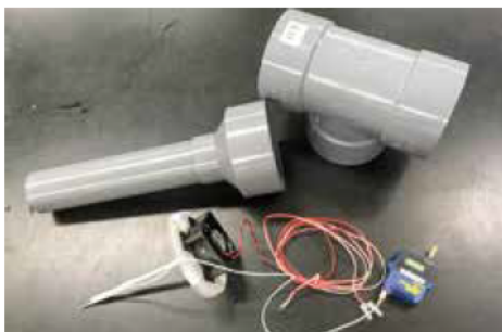
スマート農業展示会に展示した簡単に制作できる強制通風筒
