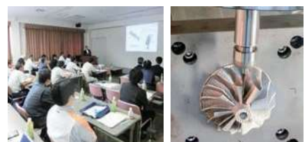
金属加工・技術セミナー インペラの同時5軸加工
