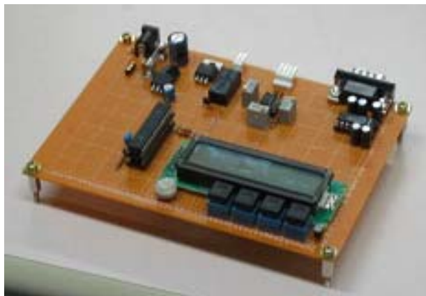
図4 試作した温度制御装置の外観
