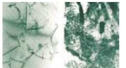
金属の断面の様子(電子顕微鏡写真) 糸状に見えるのが金属に堆積した転位です。
