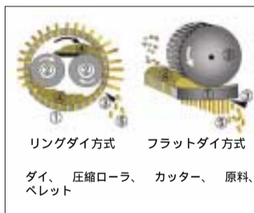
図1. 木質ペレットの製造方法
