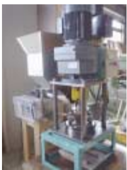
写真3. 開発したフラットダイペレタイザー
